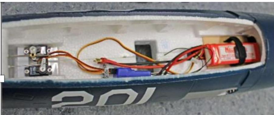
Rumpf vor dem Einbau der Sperrholzplatte für den Umlenkhebel. Beachten Sie die eingebauten Höhen- und Seitenruder-Servos.
