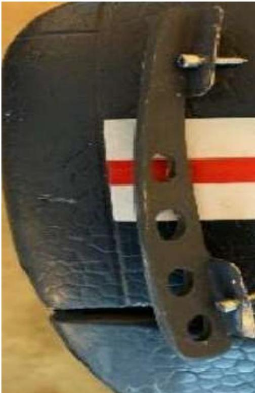
Die Führung wird für die Baubewertung entfernt. Sie wird von zwei Blechschrauben gehalten, die in Lindenholzblöcke geschraubt sind, die in den Schaumstoff-Flügel eingeklebt sind.
