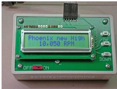
Um den ausgeschalteten FM-9 Programmer in Betrieb zu nehmen, wird der Servostecker vom Timer abgezogen (**VORSICHT; Verbindung Batterie-Regler zuerst trennen**) und die 6-adrige Verbindung zum Programmer angesteckt. Die **rote Markierung** ist **rechts**.
